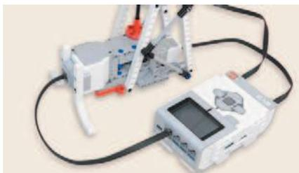
7. Соедини вторым кабелем 25 см большой мотор основания башни и порт D модуля EV3.
