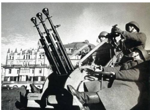
принимается 12.7-мм. станковый пулемёт ДШК (Дегтярёва-Шпагина крупнокалиберный) на универсальном станке Колесникова. Для стрельбы по воздушным целям пулемёт был снабжен специальными зенитными прицелами.
