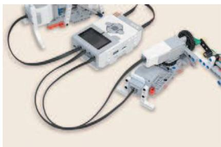
9. Вставь один конец кабеля 35 см в разъем среднего мотора на приводе пушки, а второй конец — в порт А модуля EV3.
