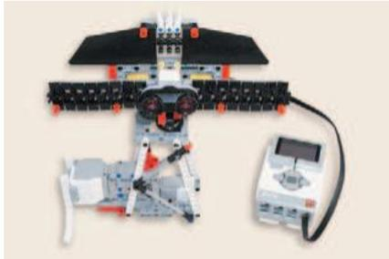
5. Вставь один конец длинного кабеля 50 см в разъем ультразвукового датчика, а второй конец — в порт № 4 модуля EV3.
